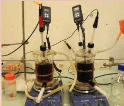
Mini-bioreacteur pour LAB culture (10 l).
